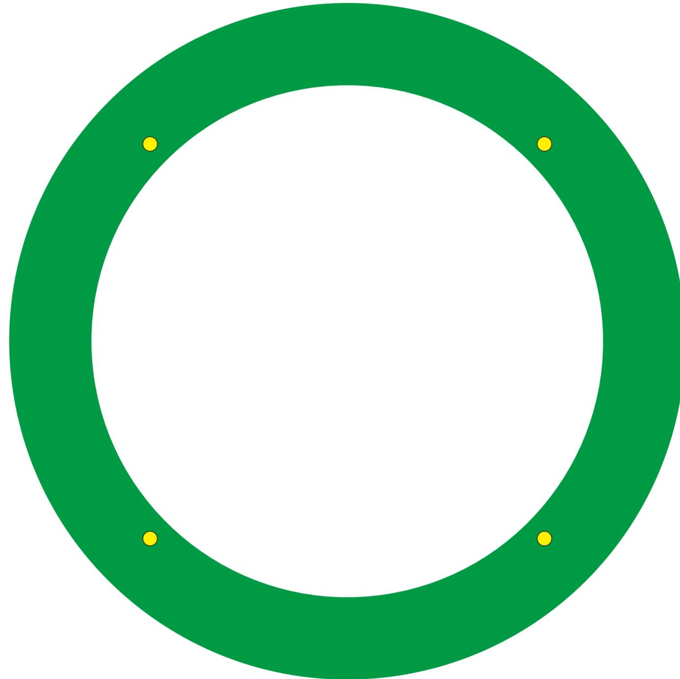
**中間層(2層目)アルミ1.0mm、外径φ186mm、内径φ142mm**
