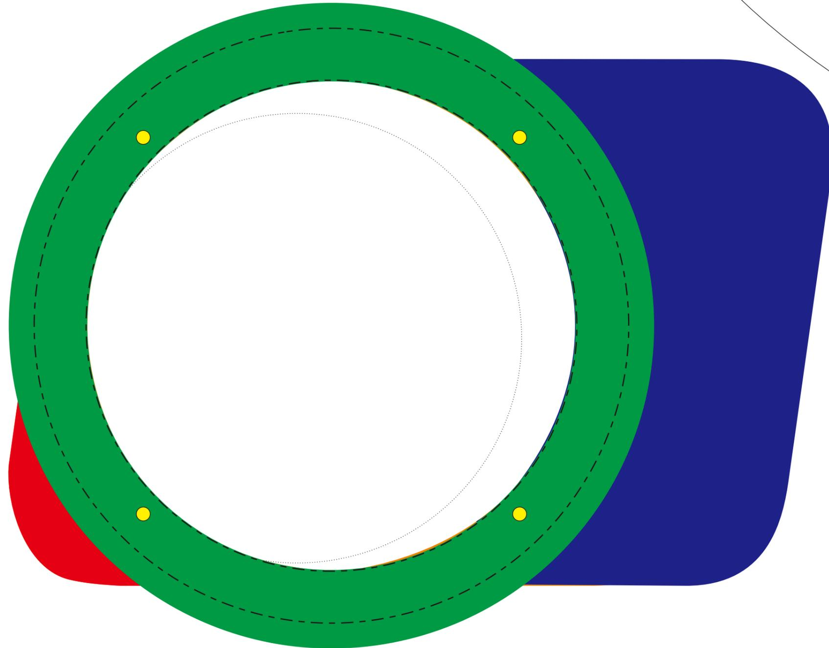
**最上層(3層目)アルミ1.5mm、外径φ186mm、内径φ142mm**
